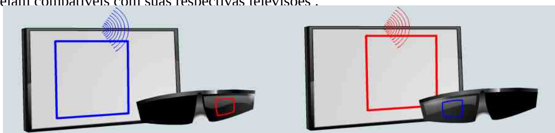
Figura 5 - Televisão e óculos com chip mostrando o efeito de sequenciamento e sincronização entre óculos e televisão.
