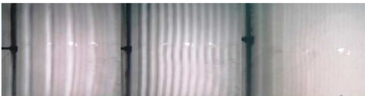
Figura 16 – Ondas retas com frequência e 8Hz, 20Hz e 60Hz. Ondas em frequências maiores são difíceis de enxergar, pois é necessário utilizar uma amplitude muito pequena para não espirrar água para todos os lados.
