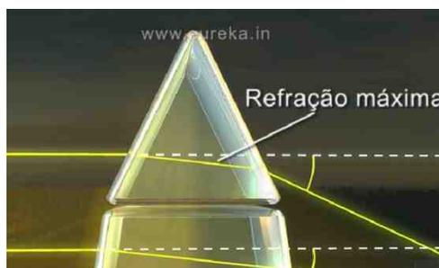
**Figura 02.** Representação de prisma superior e luz incidente sofrendo refração máxima.
