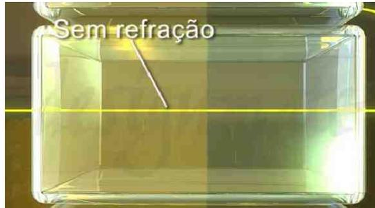
**Figura 03.** Representação de prisma interno e luz incidente não sofrendo refração.
