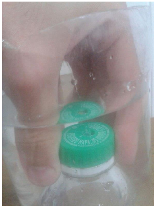
Imagem 4: Parte observada para ver se saem bolhas de ar.
