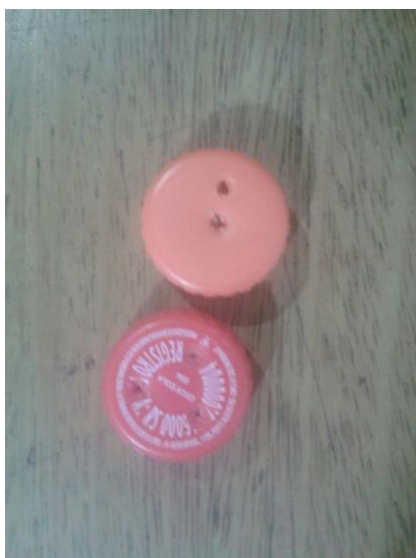
Imagem 9: Tampinhas com dois e três furos de 3mm cada.
