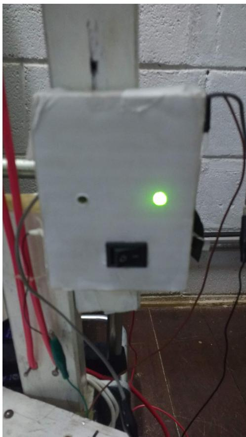
**Figura 7: interruptor e LED verde ligados, mostrando que o experimento está pronto e seguro para uso**
