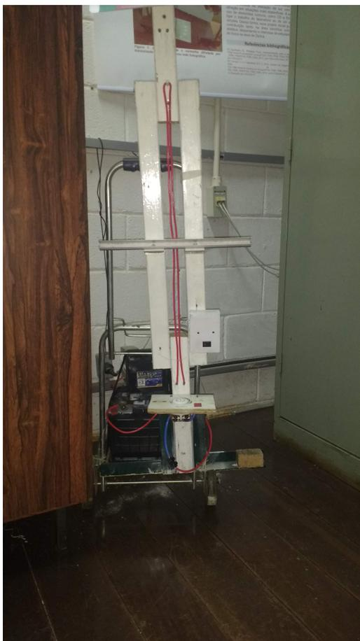
**Figura 1: Montagem atual do experimento “Força entre Correntes”**
