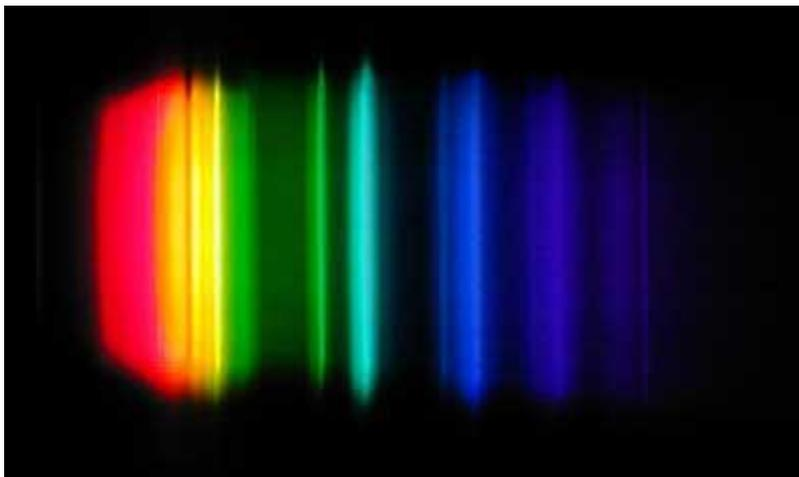
**Figura 6.** Espectro da luz emitida por uma lâmpada de vapor de sódio de alta pressão.
