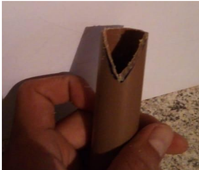
Figura 7 : Corte em "V" em uma das extremidades do cano para encaixe do laser.
