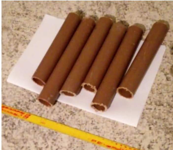
Figura 6 : Corte do cano em aproximadamente 10 cm de comprimento.
