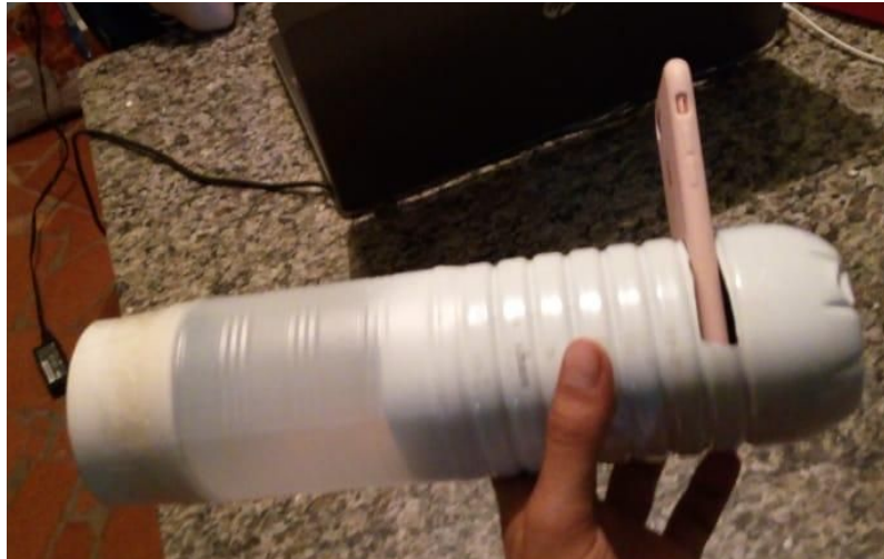
Figura 9 : Montagem das garrafas.
