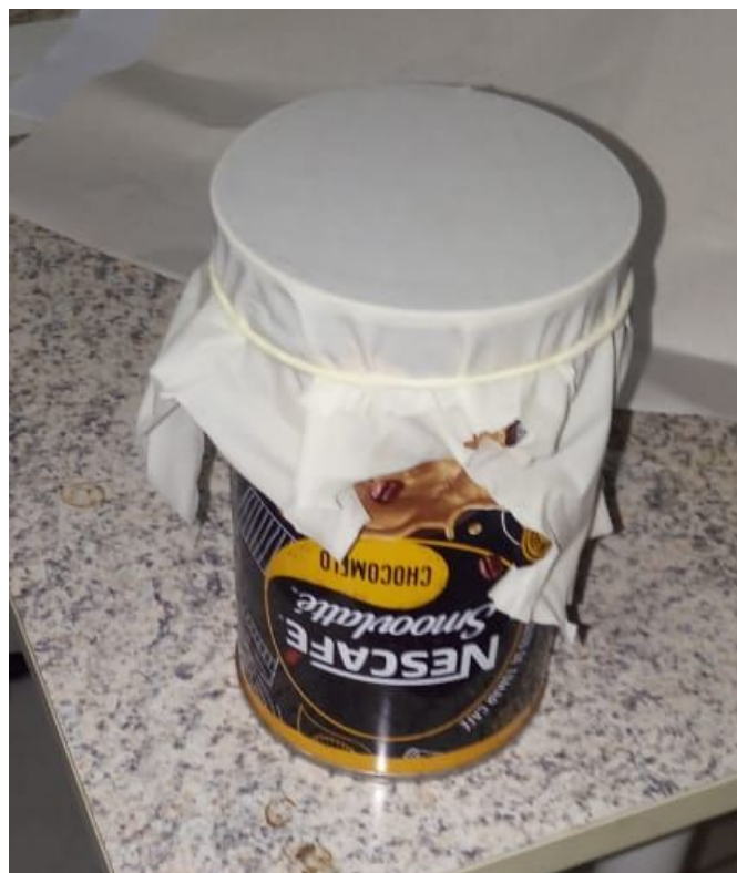
Figura 5 : Luva de látex esticada em uma das extremidades da lata.
