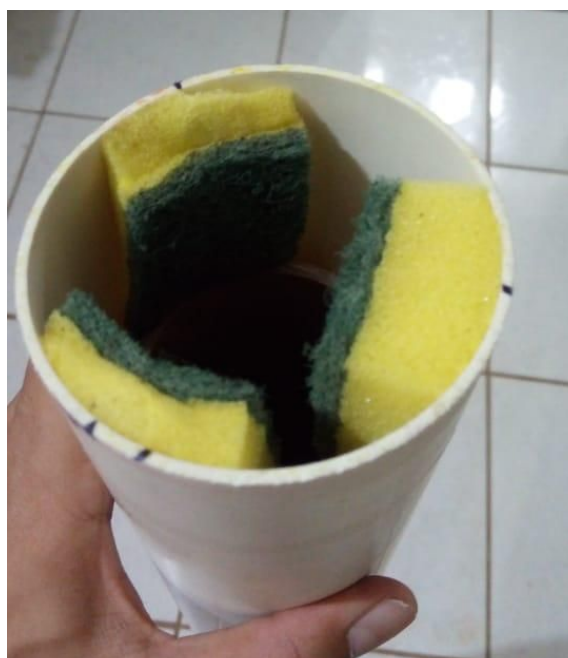
Figura 13 : Colagem da bucha cortada no cano maior.
