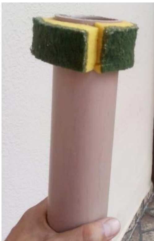
Figura 12 : Colagem da bucha cortada no cano menor.
