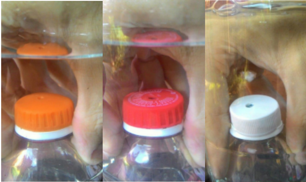
Imagem 11: Experimento com álcool etílico diluído 46º inpm. Tampas com furos de 3mm e 4mm (esquerda e centro) sem vazar ar e tampa de 5mm (direita) com ar vazando.
