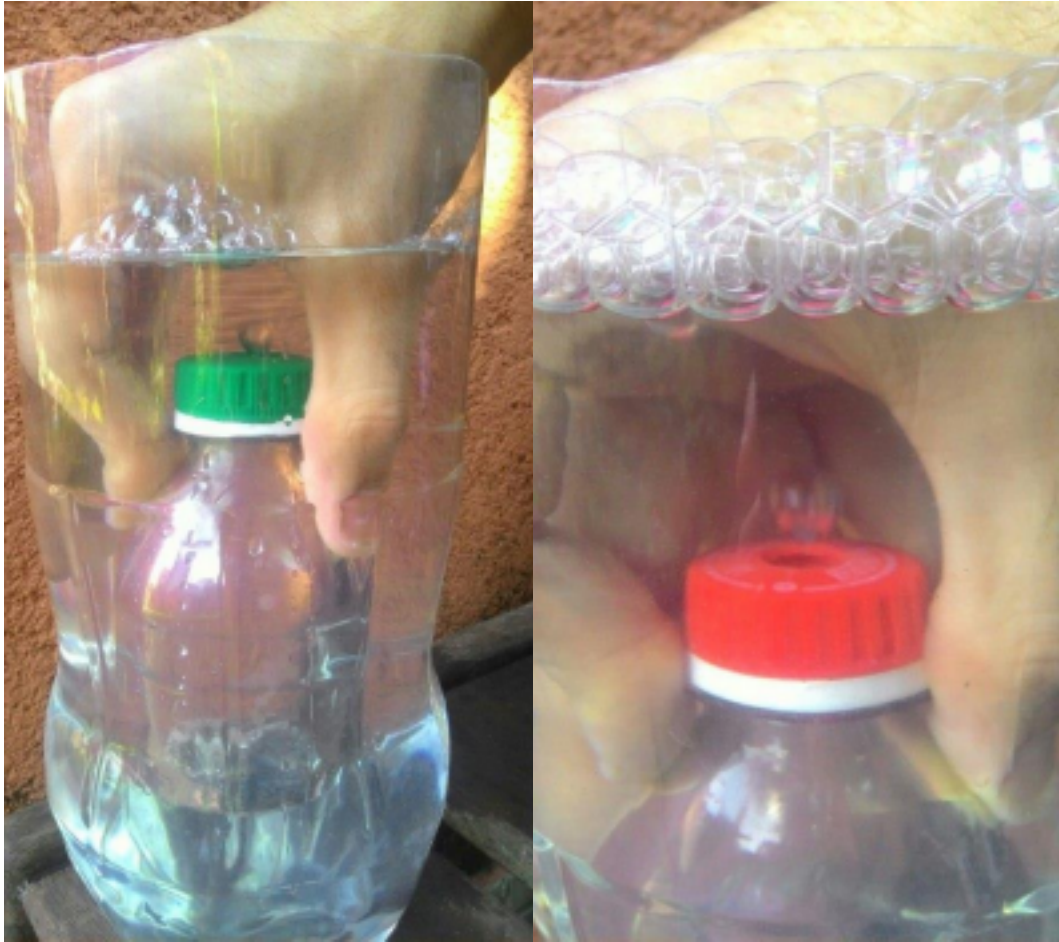
Imagem 10: Experimento com água misturada com uma colher de sopa de detergente líquido. Tampa com furo de 10mm (esquerda) e tampa com furo de 11mm (direita).
