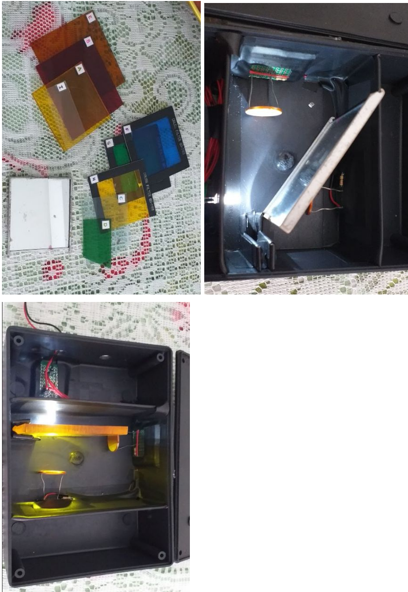
Figura 02: (a) filtros empregados no experimento, (b) experimento na função de refletância, (c) experimento na função de transmitância empregando filtro laranja.
