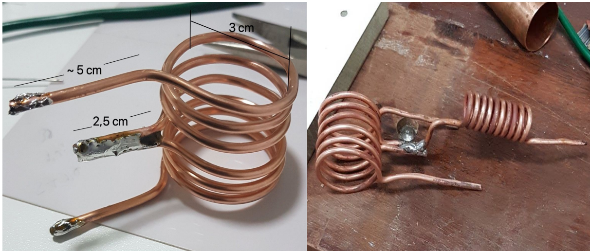
Figura 12: Figura da esquerda: indutores de 3 volts soldados em sequência. Figura da direita: indutor de 10 volts soldado em perpendicular com as outras duas.
