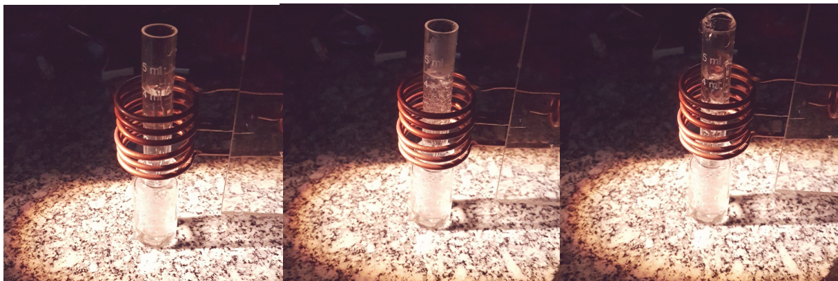
Figura 17: aquecimento de água por indução. Na primeira imagem a água está em temperatura ambiente, na terceira se encontra no estado de vaporização. O tempo para o processo foi de 30 segundos.
