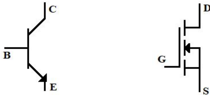
Figura 2: A esquerda o transistor bipolar: B C e E representa a base, coletor e emissor. A direita o MOSFET: G, D e S representa o Gate, Dreno e Source.
