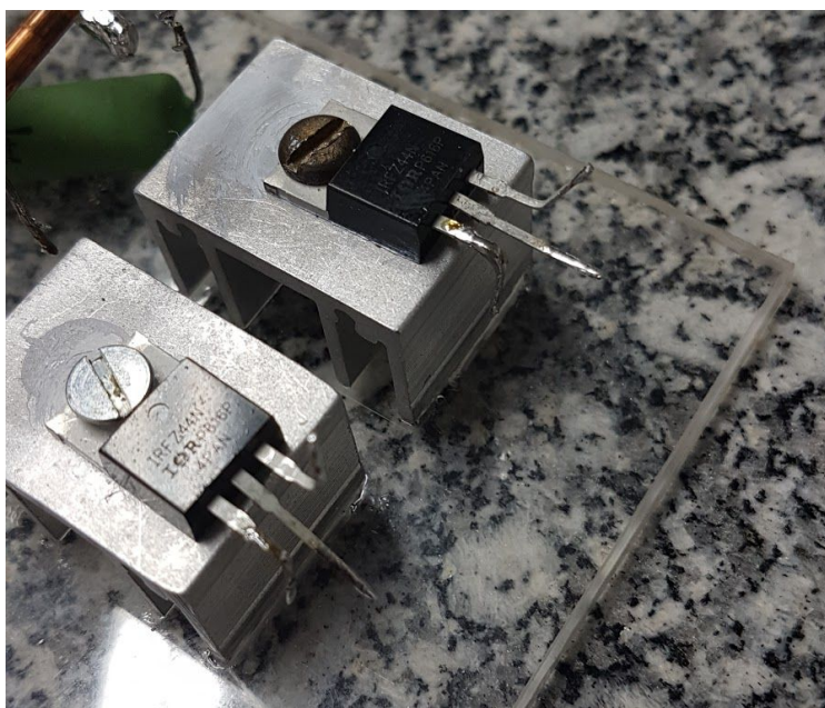
Figura 19: Imagem dos transistores queimados. Transistor da esquerda está curto-circuitado e o da direita está aberto. Foi necessário trocar as peças.
