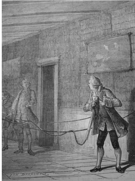
Figura B.9: Gray frota con las manos desnudas su tubo de vidrio flint de un metro de largo. Un cordón de empaque conectado al tubo está sostenido por un hilo de seda. Una bola de marfil conectada al otro extremo del cordón atrae la hoja de latón situada debajo.
