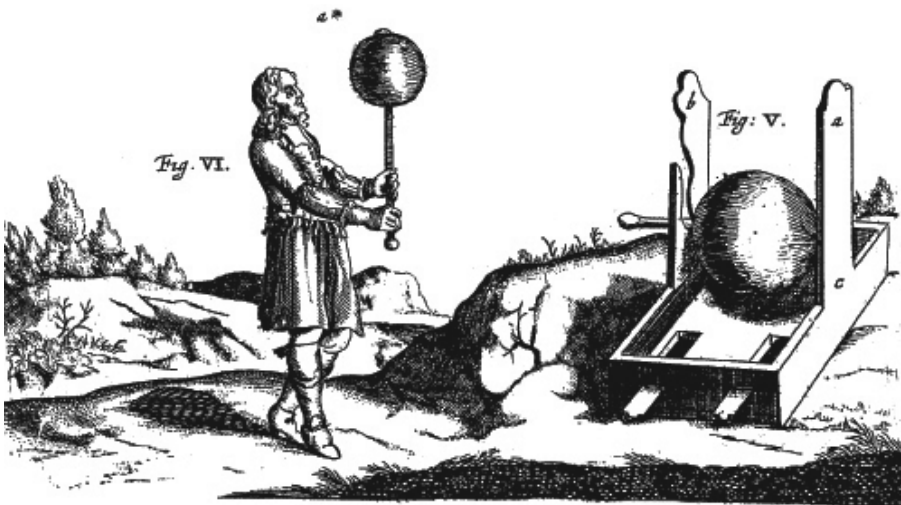
Figura 4.7: El experimento de Guericke, en el que mantuvo un plumón suspendido sobre un globo de azufre frotada, así como su máquina eléctrica.
