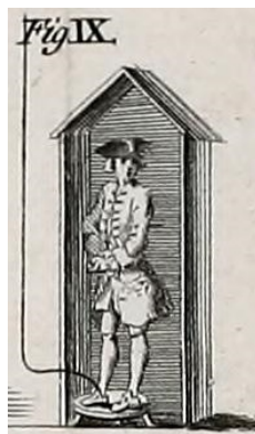
Fig. 11.15 : L'expérience de la guérite suggérée par Franklin.
