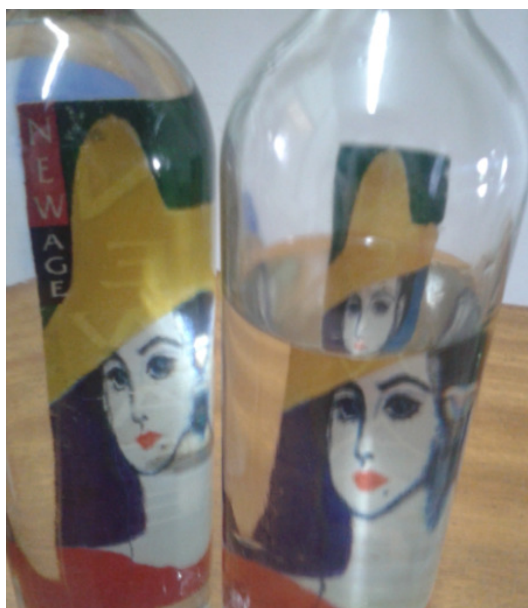
Figura 26 – Imagem da BELLA DONA através da garrafa preenchida totalmente com água e na garrafa à direita, parcialmente com água e parcialmente com ar.
