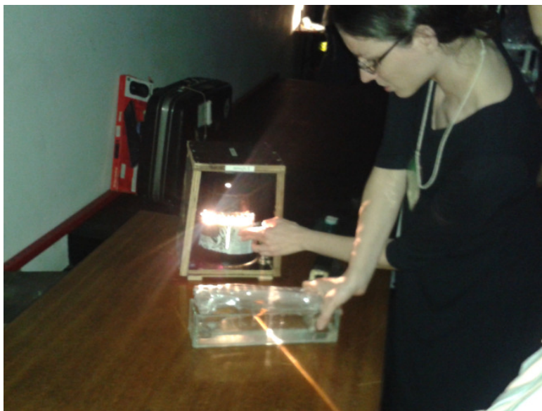
Figura 29 – Aluna Clarissa apresentando um experimento de REFRAÇÃO, utilizando a fonte de luz de um feixe e a cuba de água.
