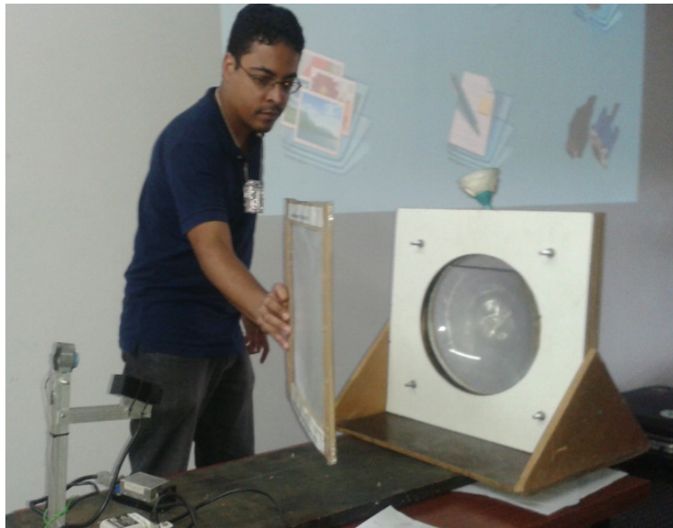
Figura 34 – Aluno Cassemiro utilizando a lente de glicerina com água para demonstração do ponto focal de convergência da luz.
