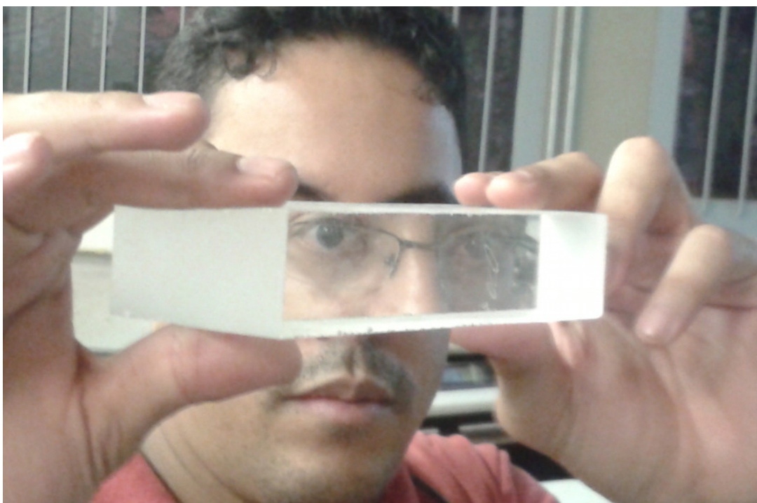
Figura 33 - Utilização do PRISMA QUEBRA-CARA. Pode-se notar que devido à REFRAÇÃO e a rotação do prisma, houve um deslocamento da parte intermediária da cara do Cassemiro. As partes superiores e inferiores de sua cara permanecem onde estão.
