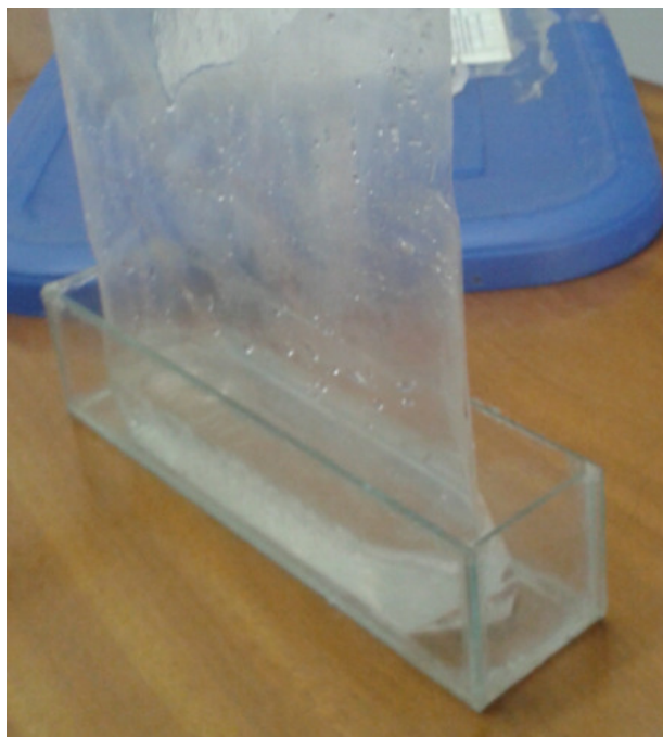
Figura 30 – Cuba de vidro com saco com água utilizado para observação da refração de um feixe de luz.
