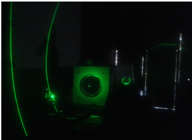
Figura 35 – Apresentação do experimento da lente com água para demonstração do ponto focal de convergência da luz.
