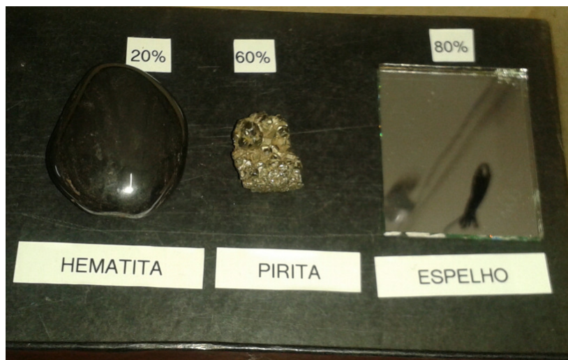
Figura 17 – Reflexão da hematita polida – 20%, da pirita – 60% e do espelho – 80%.
