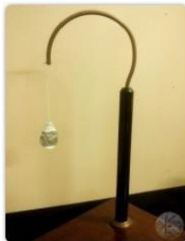
Com este equipamento vários conceitos, como por exemplo, o de eletrização por atrito, eletrização por Indução e quando em contato, eletrização por contato, Polarização por indução elétrica, Influência de um campo e de forças elétricas, entre outros, podem ser abordados.
