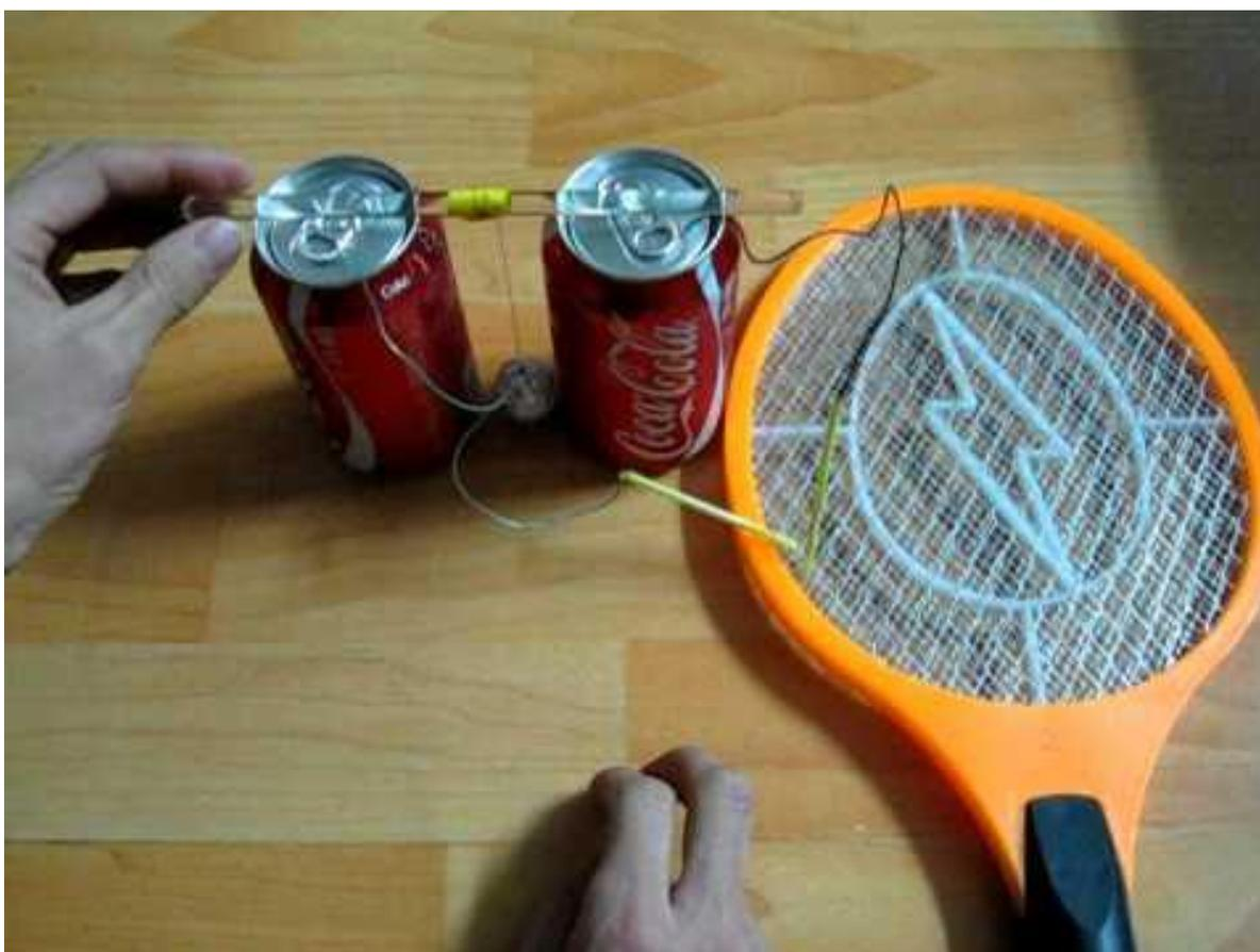
*Imagem da montagem do experimento do pêndulo eletromagnético*
