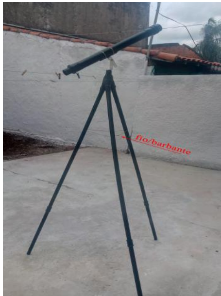
Figura 14: Montagem da luneta com tripé.
