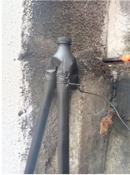
Figura 11: Fixação da garrafa PET na parte superior do tripé
