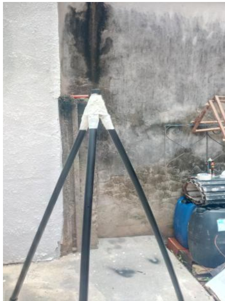
Figura 12: Isolação dos arames com fita crepe
