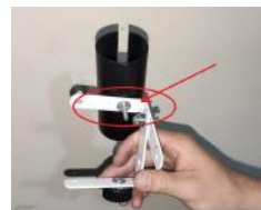
(b) Fixação do pedaço de 12cm na cantoneira L
