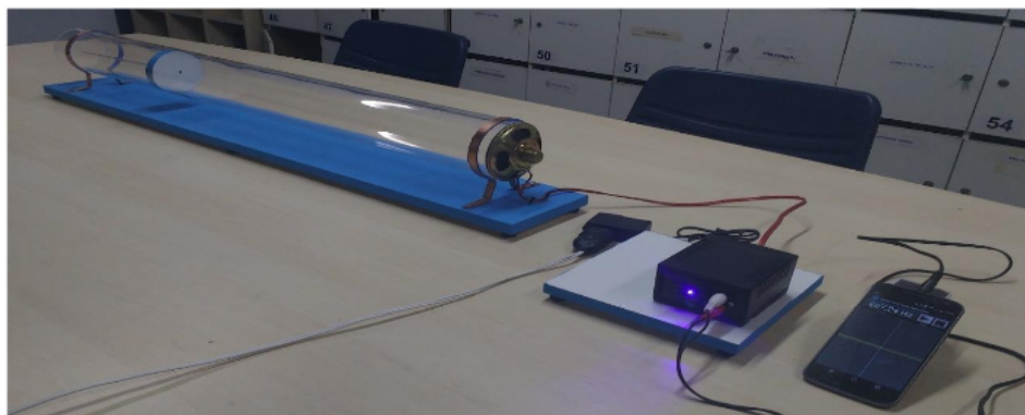
Figura 1: Montagem moderna para o Tubo de Kundt utilizada em atividades realizadas durante um mestrado profissional na Universidade Federal Rural de Pernambuco. Ref [3].
