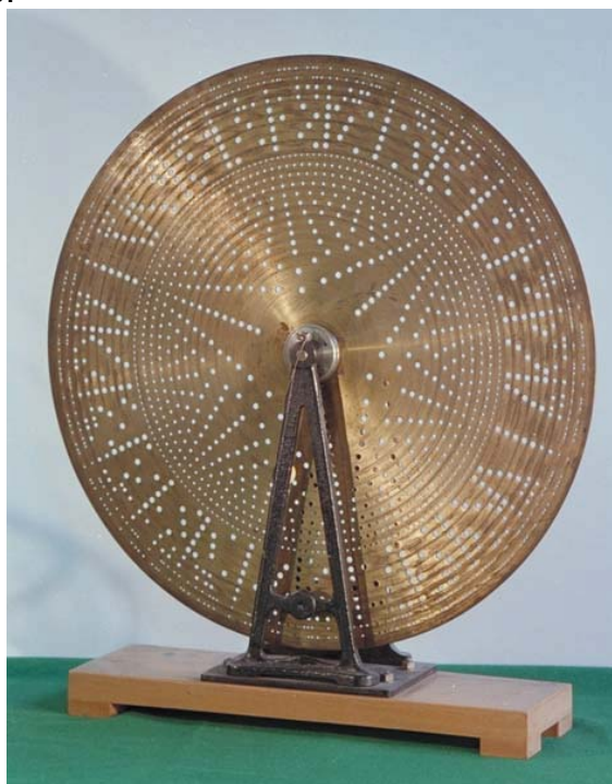
Fig.1 – Disco de Seebeck (Diâmetro 50cm)
