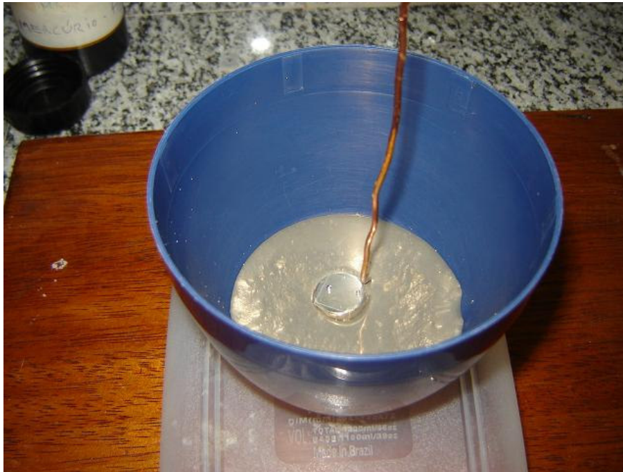
Figura 12 – Esquema mostrando o fio solto de cobre, o mercúrio e o ímã de neodímio ao centro. Note que o ímã está fixado ao fundo do pote com durex.
