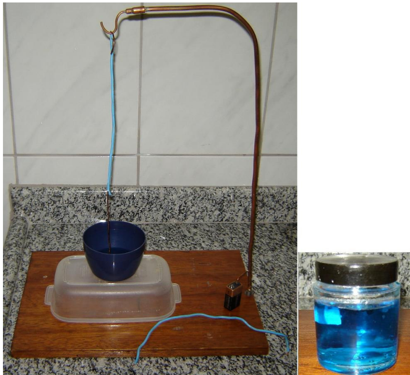
Figura 11 – Esquema do motor de Faraday utilizando o sulfato de cobre. O fio azul mostrado abaixo serve para fechar o circuito entre a bateria e o líquido. O pote transparente abaixo do azul serviu apenas para ajustar a altura, já que o fio de cobre era menor que a altura do suporte. Ao lado direito vemos em detalhe a solução azulada do sulfato de cobre.
