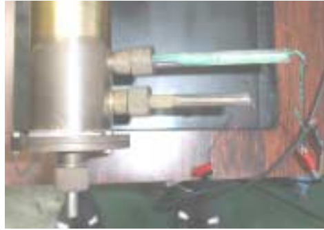
Fig 4: disposição dos PZTs no tubo de onda de choque (com fios verdes o primeiro PZT e com fios vermelhos o segundo)
