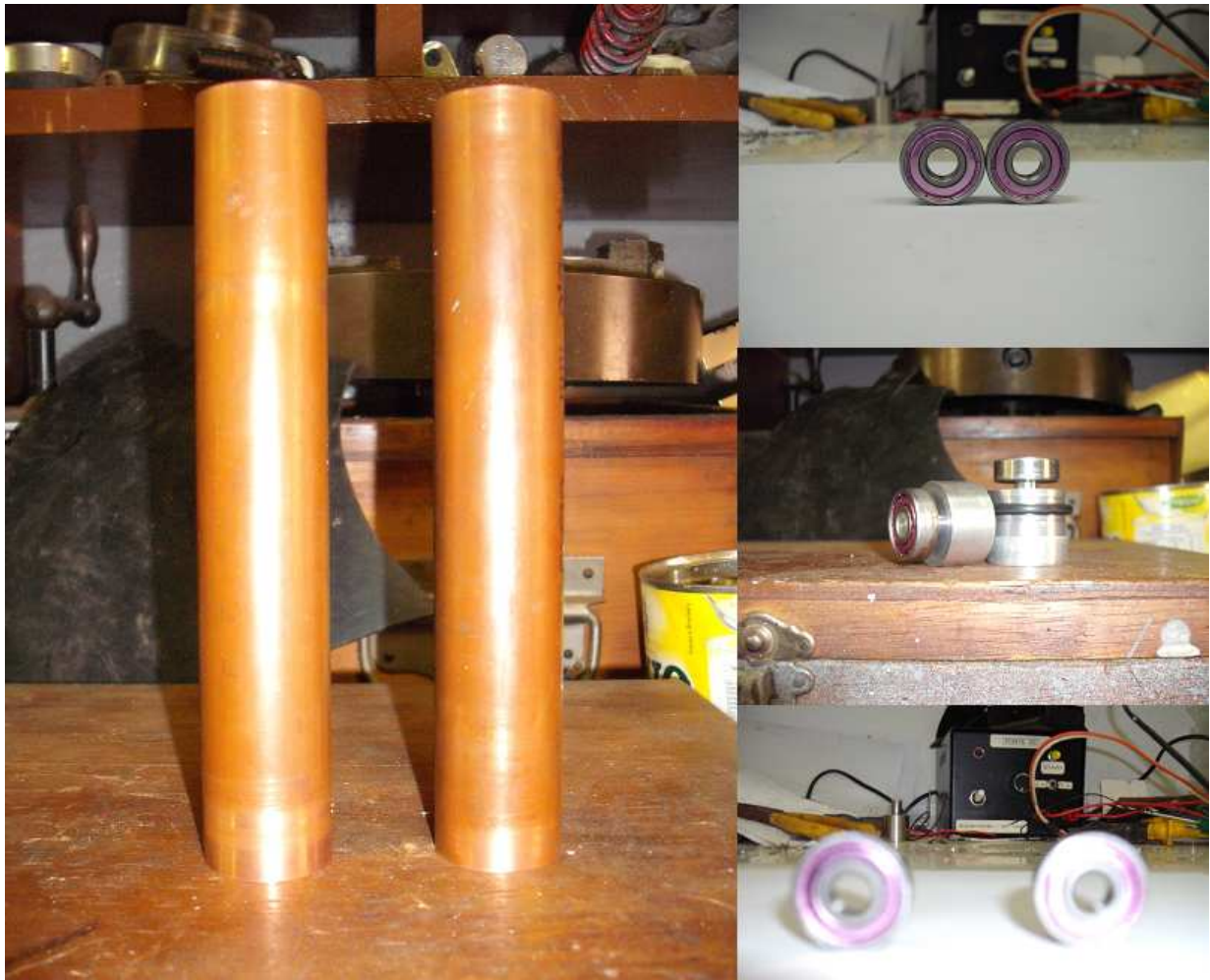
Figura 10: Tubos de cobre rolamentos e rolamentos acoplados nas buchas.
