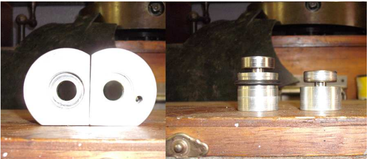
Figura 9: Mancais e Buchas, dispositivos para acoplamento dos tubos de cobre
