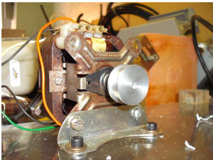
Figura 12: Motor elétrico, utilizado para o trabalho de giro dos cilindros.
