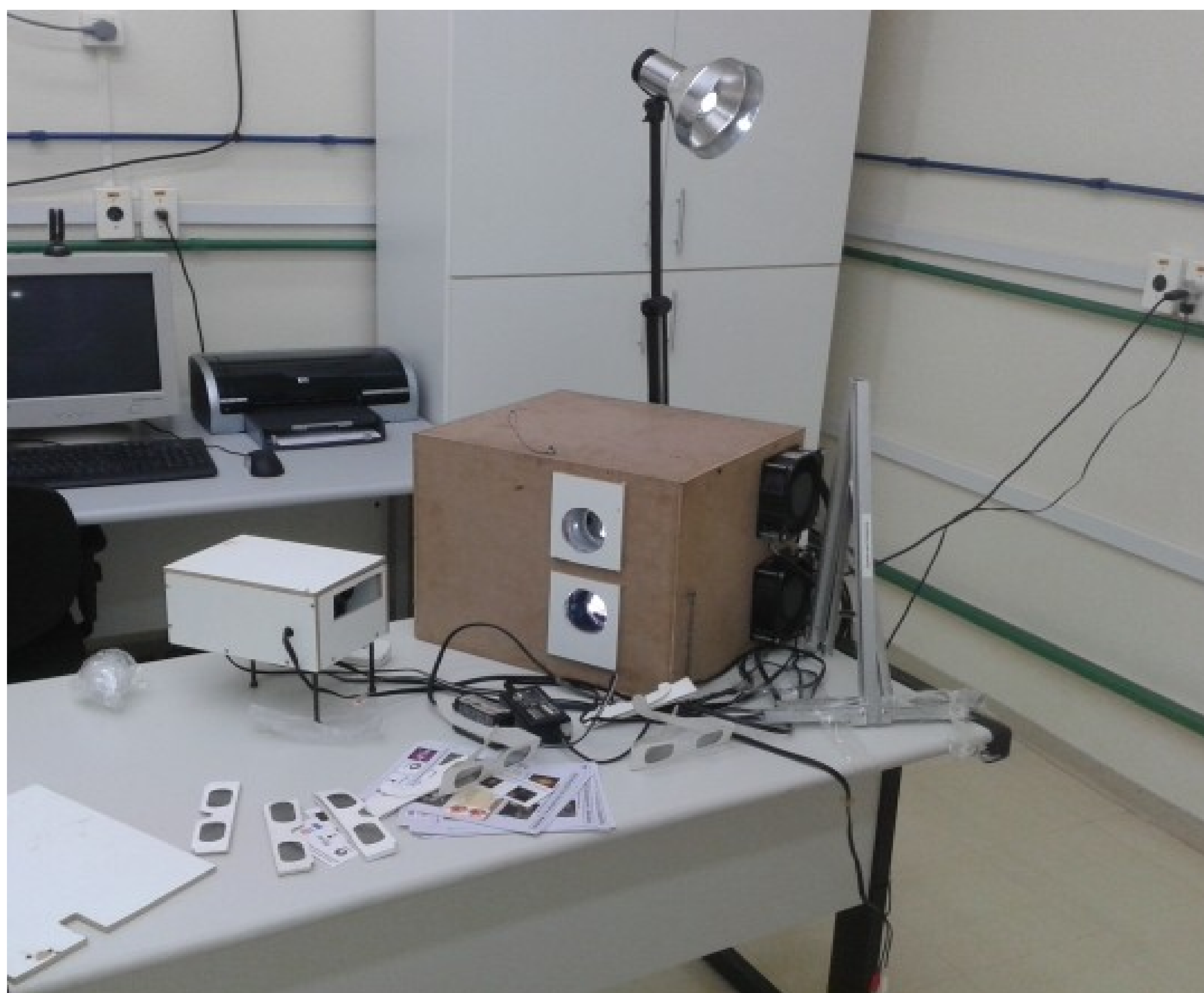
Foto 1: Caixa da câmera dupla apontando na direção de iluminação e, a direita, a caixa do projetor duplo. Na mesma mesa, tradicionais óculos em cartolina polarizados linearmente.
