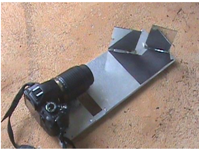
Figura 3 Adaptador 3D com dois espelhos feito para a Câmera NIKON, realizado por Rafael Pedro da Silva.
