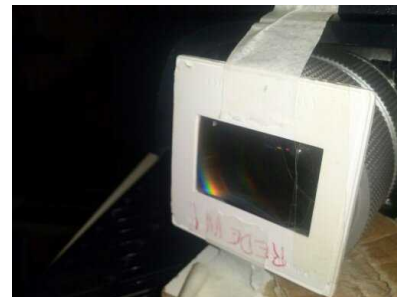
Figura 7: Rede difratora a frente da lente.
