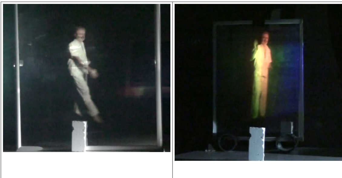
Fig. 10: comparando a posição da imagem em um falso holograma (esquerda) com a de uma holotela (direita).
